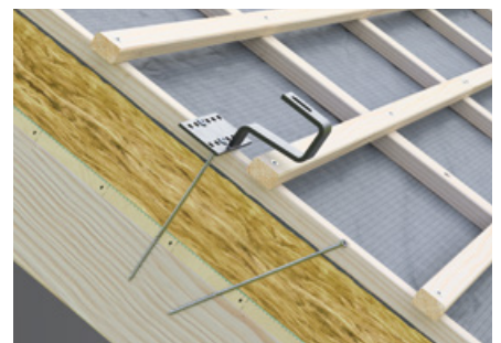
Montage de crochets de toit solaires
